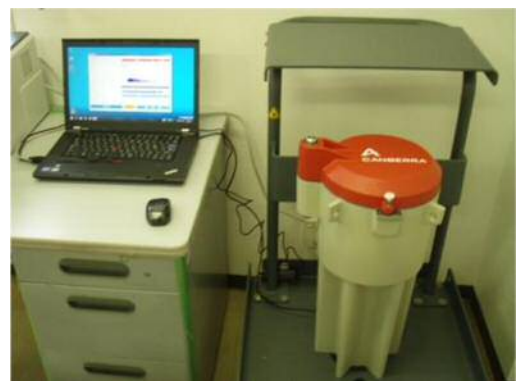
食品放射能測定システム
