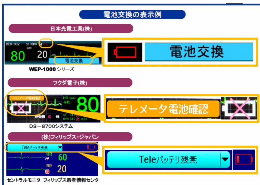
図 22 電池交換の表示例
