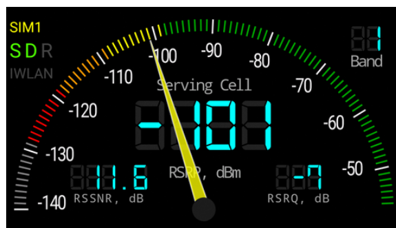
図 47 スマートフォンのアプリでの携帯電話の電波の強さの表示例
