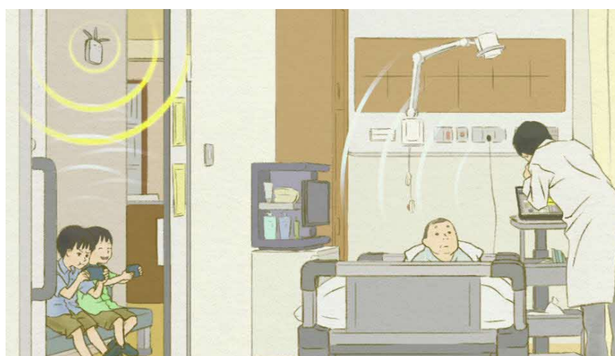
図 37 持ち込み端末や管理外の無線 LAN AP 等による電波干渉
